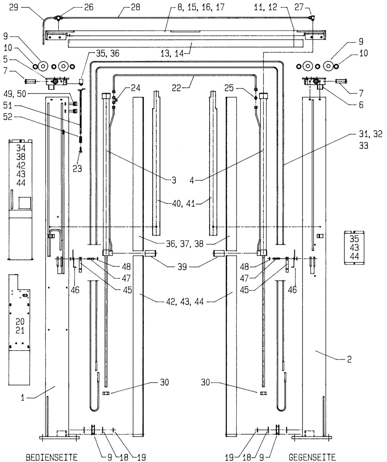
**Ersatzteilliste: Hubsäulen, Abdeckungen, Zylinder, Seile**
